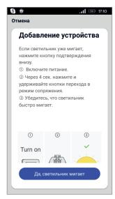
3. Включите светильник настенным выключателем. Через 4 секунды (но не позже чем через 8 секунд) нажмите и удерживайте на пульте кнопки сопряжения, отмеченные значком . Вход в режим сопряжения сопровождается миганием света (около 2-х раз в секунду).
